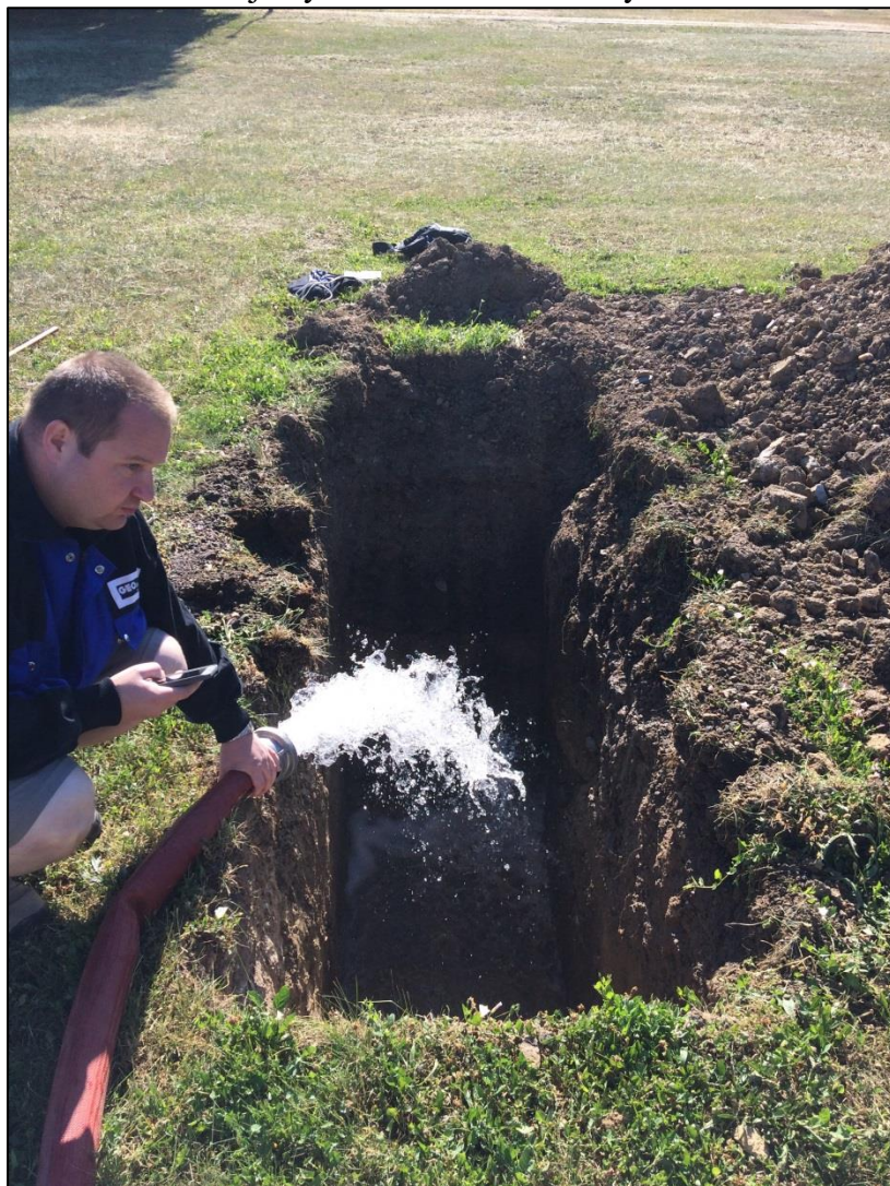
Plnění vsakovací jámy VS 2 vodou z cisterny Obr. č. 5.2.3
