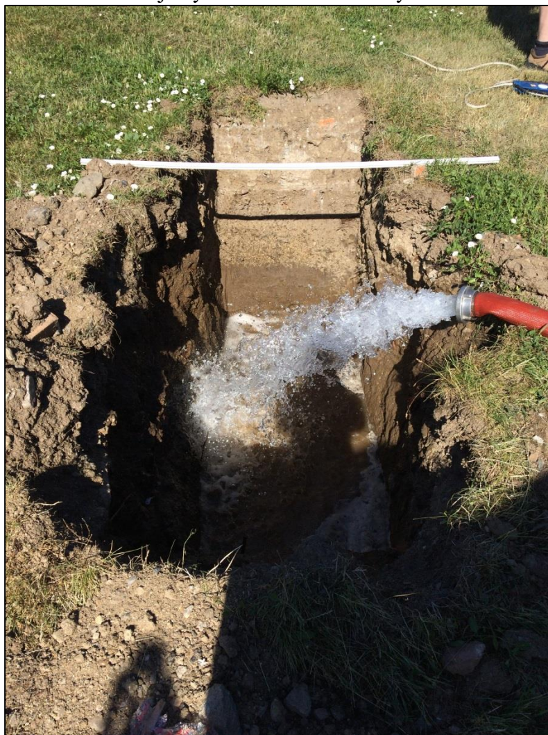
Plnění vsakovací jámy VS 3 vodou z cisterny Obr. 5.2.4
